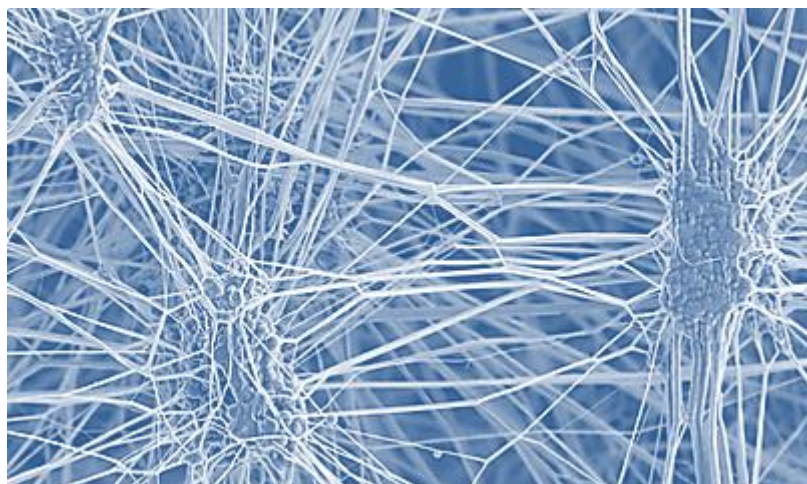
Рисунок 3.5 – Структура пористой из ПТФЭ мембраны Gore-Tex под электронным микроскопом [26]
